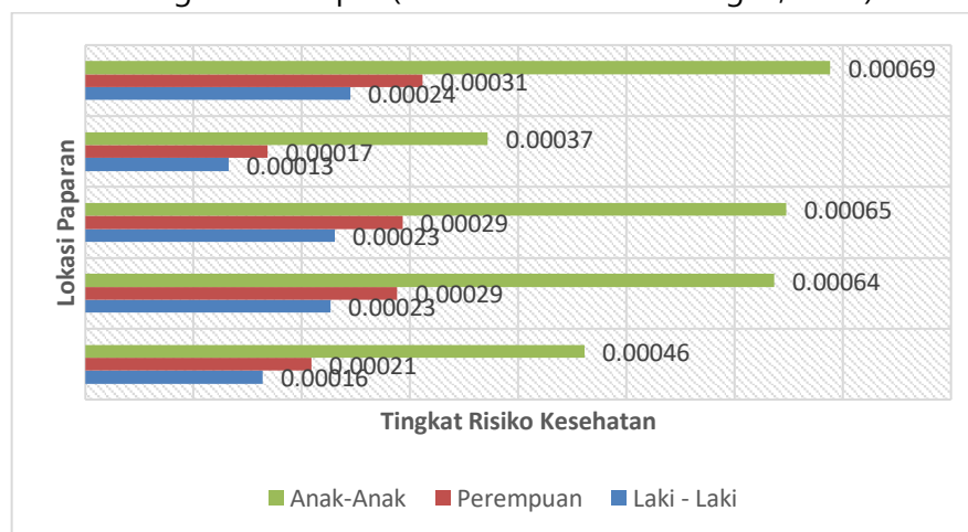
Gambar 5. 5 Tingkat risiko kesehatan paparan TSP pada kegiatan pembongkaran bangunan tahap 3 (Sumber: Hasil Perhitungan, 2025)
